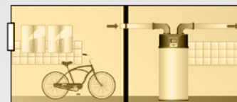
Zajem toplega zraka v kolesarnici in izpih hladnega zraka na prosto
