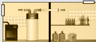
Zajem toplega zraka v kurilnici in ohlajanje vinske kleti
